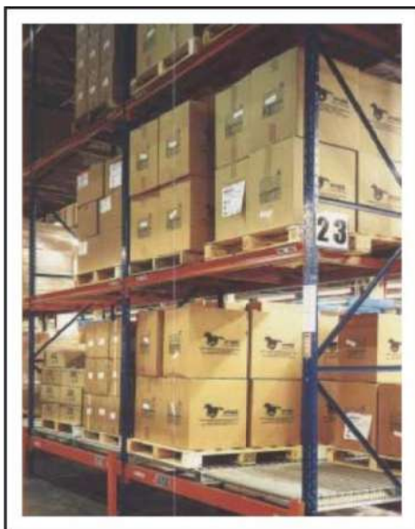
Fig: 34 - Porta-paletes deslizante
