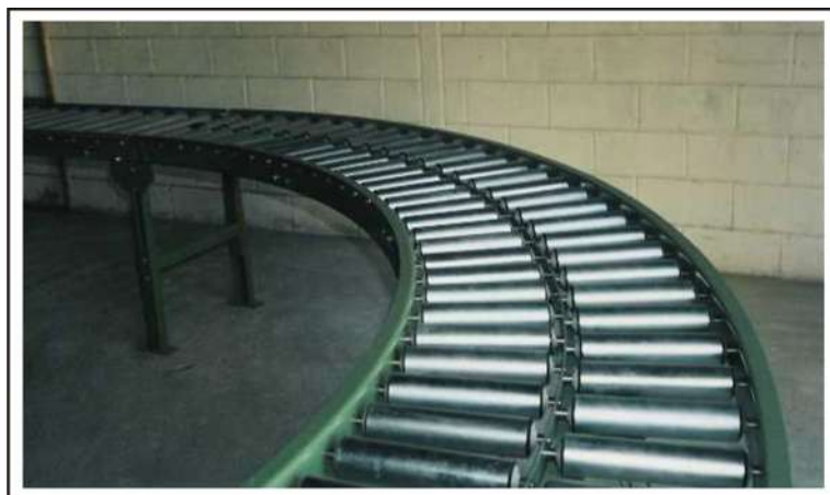
Fig. 11 - Equipamento de movimentação com roletes - Uso da gravidade
