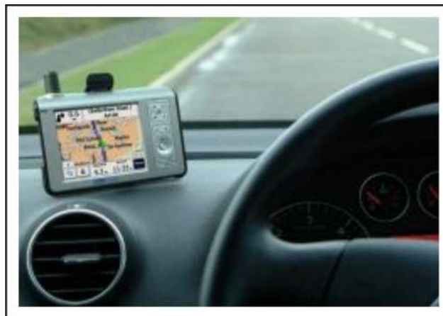
Fig. 33 - Sistema GPS instalado em veículo rastreado
