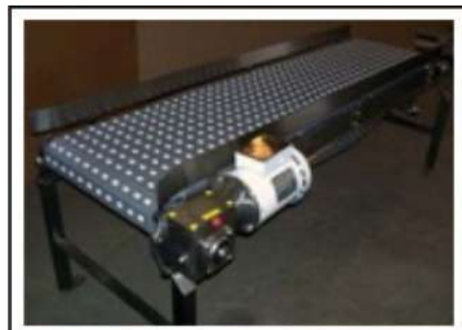
Fig. 71 – Transportador de correia plástica com saliências
