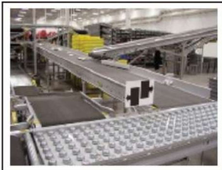
Fig. 74 – Mesa de esfera transferidora
