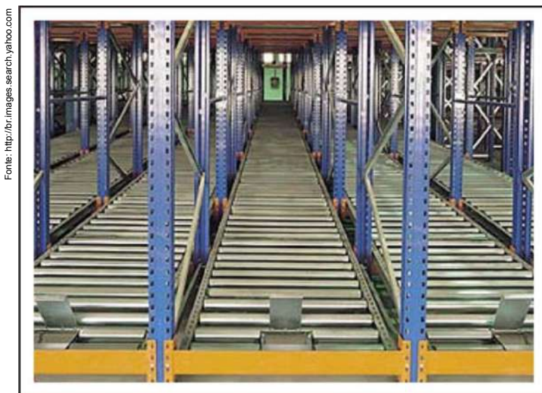
Fig. 38 – Porta-paletes com estrutura dinâmica
