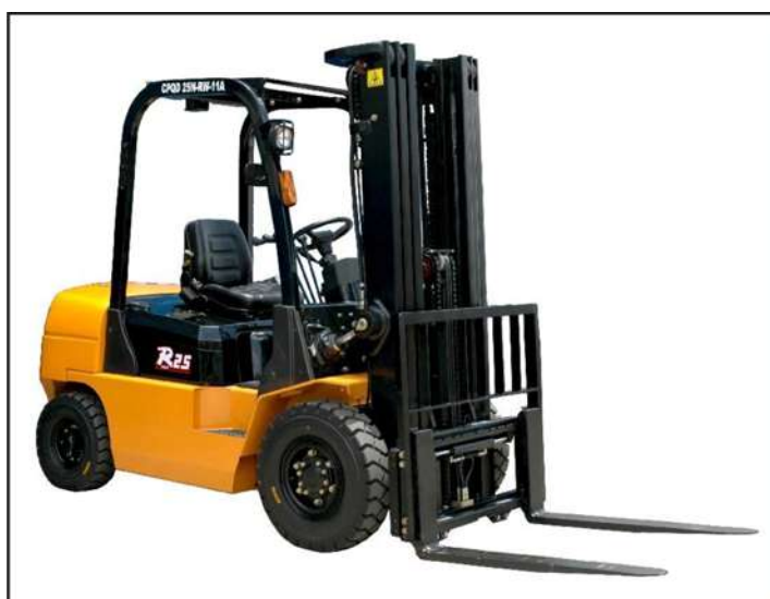
Fig. 9 - Empilhadeira de para cargas até 2,5 t
