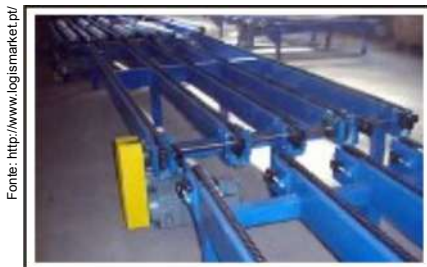
Fig. 72 – Conjunto de transportadores de corrente
